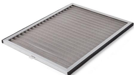
Viene realizzato in acciaio inossidabile per garantire una lunga durata nel tempo ed una facile lavabilità con acqua corrente . La speciale forma plissettata a microonda , serve ad aumentare la sua superficie in relazione alla sezione di passaggio dell'aria , conferendo un basso indice di sporco al filtro che potrebbe , una volta occluso , ridurre la portata dell'aria del ventilatore interno alla macchina .
